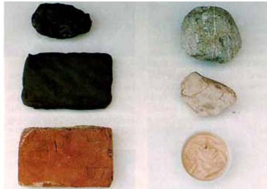
A destra : l'argilla, un mattone formato e uno finito; A sinistra : le pietre calcaree prima e dopo la cottura ed il grassello di calce ottenuto.
