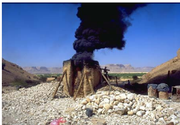
Fig. 1- Wadi Hadramut, calcara in funzione
