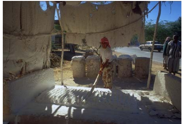
Fig.4- Idratazione manuale della calce viva
